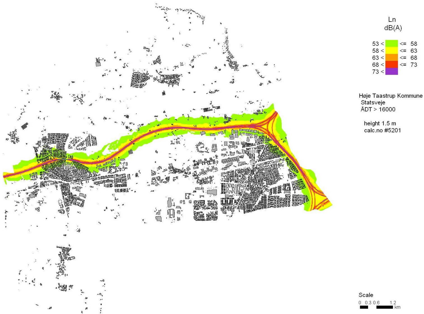
Figur 2: Motorvej. Ln 1.5m
