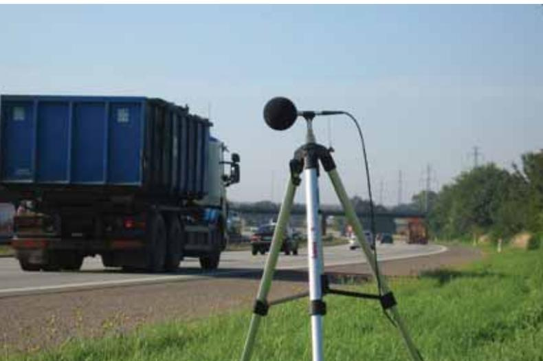
**Figur 4.** Mikrofon i vejside ved pass-by måling. Mikrofonen er placeret tæt på vejen og måler støj fra forbigående person- og lastbiler.
